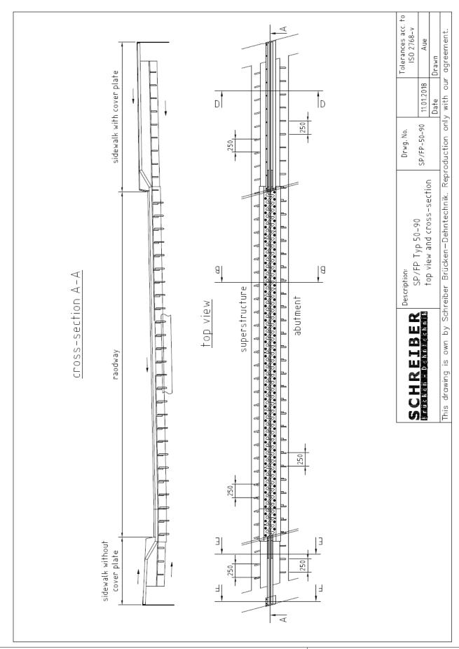
Fahrbahnübergangskonstruktion Typ SP/FP with noise reduction plate type 50/90 Standard cross section and top view
