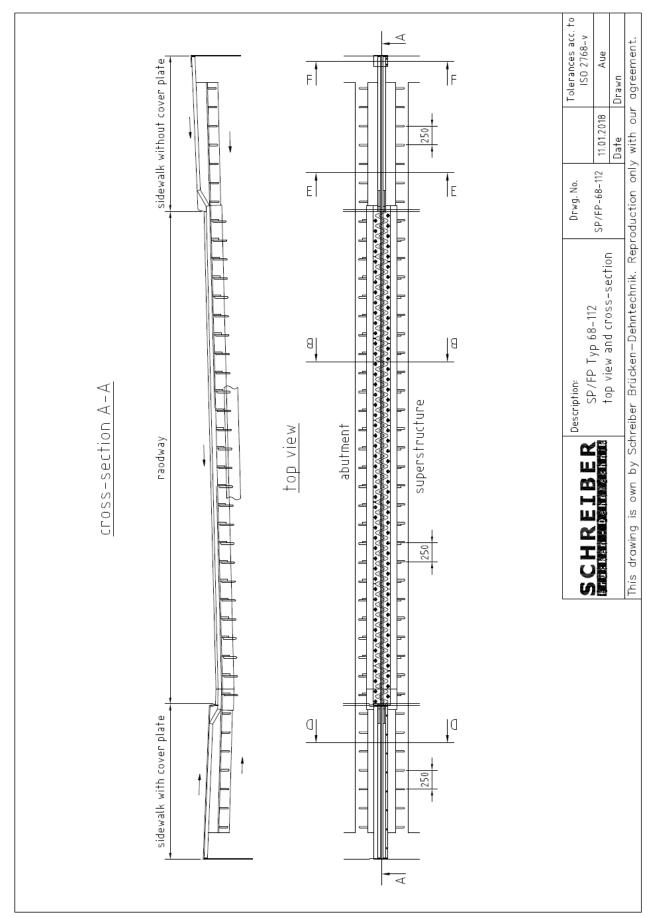
Fahrbahnübergangskonstruktion Typ SP/FP with noise reduction plate type 68/112 Standard cross section and top view
