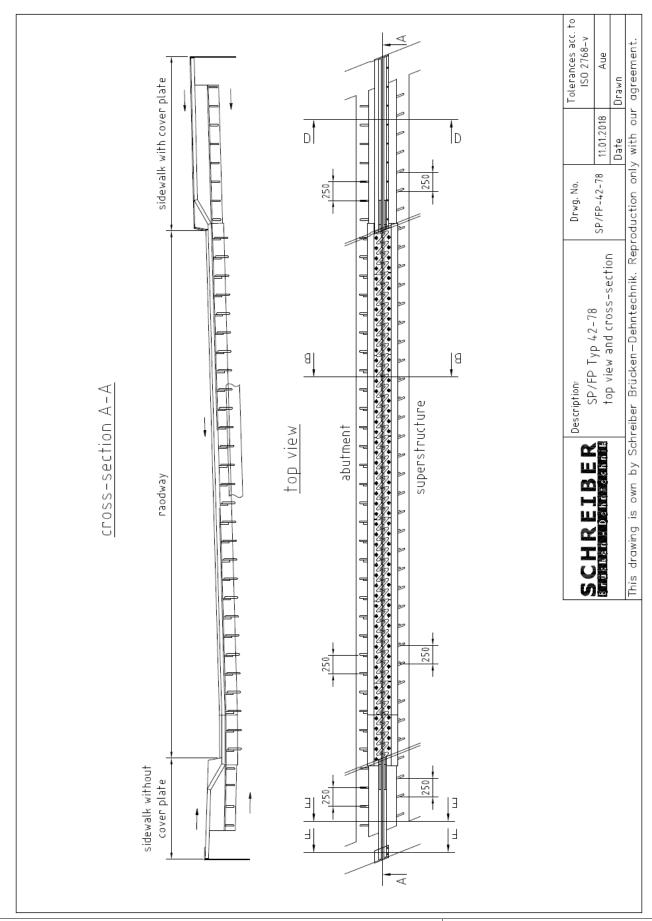
Fahrbahnübergangskonstruktion Typ SP/FP with noise reduction plate type 42/78 Standard cross section and top view
